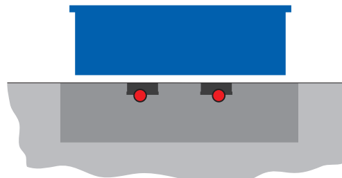
Cable tendido directamente en el suelo
